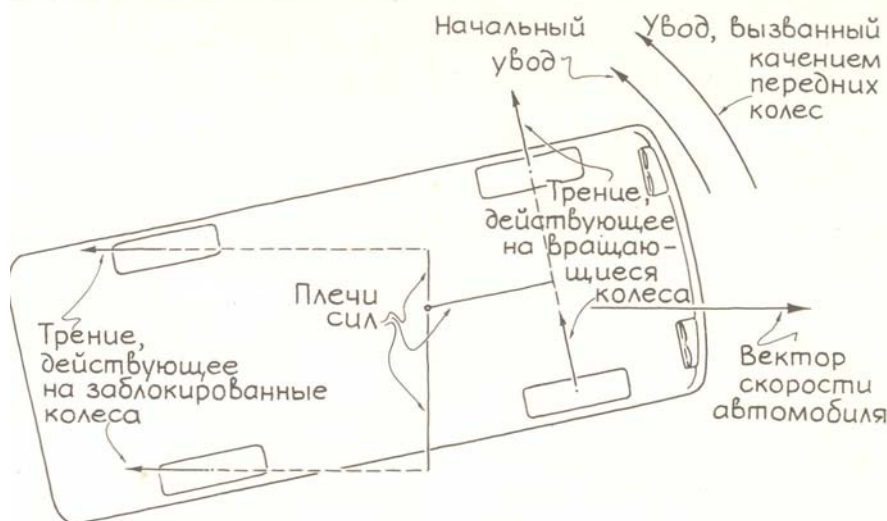
Начало увода автомобиля с заблокированными задними колесами
